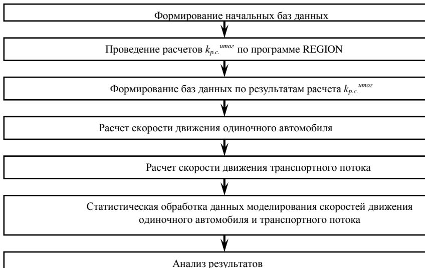
Рис. 3.7. Схема проведения расчетного эксперимента для расчета скорости движения транспортного потока на автомобильных дорогах с разными типами асфальтобетонных покрытий
