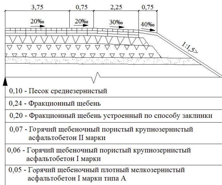
Рис. 3.2. Конструкция дорожной одежды, предложенная по проекту «Донецкгипродором»
