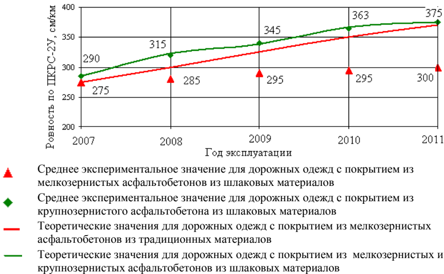
Рис. 3.5. График изменения ровности покрытий из мелкозернистого и крупнозернистого асфальтобетона со шлаковыми материалами по прибору ПКРС-2У
