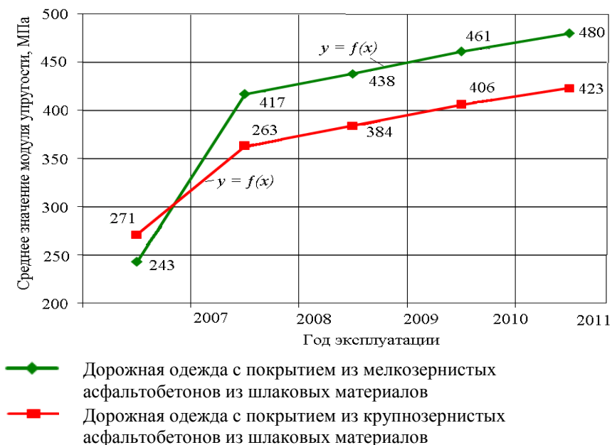
Рис. 3.4. Изменение модуля упругости дорожной одежды с покрытиями из мелкозернистого и крупнозернистого асфальтобетона со шлаковыми материалами 3.4 pav. Smulkiagrūdžio ir stambiagrūdžio asfalto su šlaku kelio dangos tamprumo modulio pokytis
