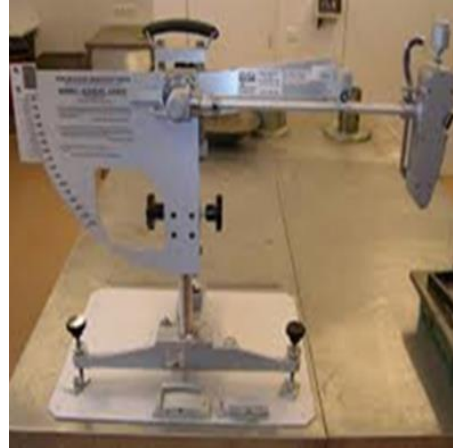
A7. pav. Trinties matavimo prietaisas (LST EN 1097-8:2009)
