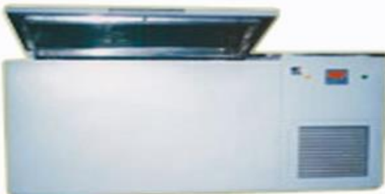
A5. pav. Vandens vonelė su piknometru (LST EN 1097-6:2013)
