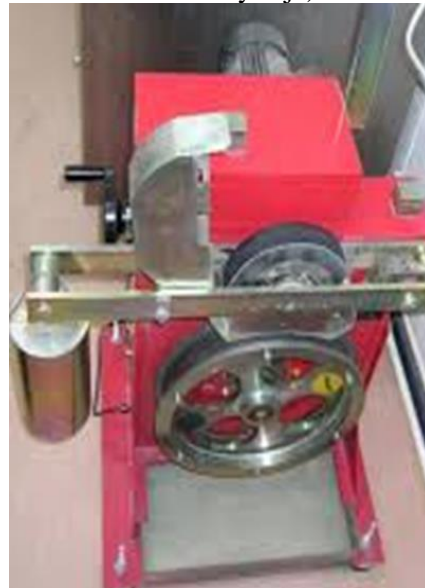
A6. pav. Poliravimo mašina ( LST EN 1097-8:2009 )
