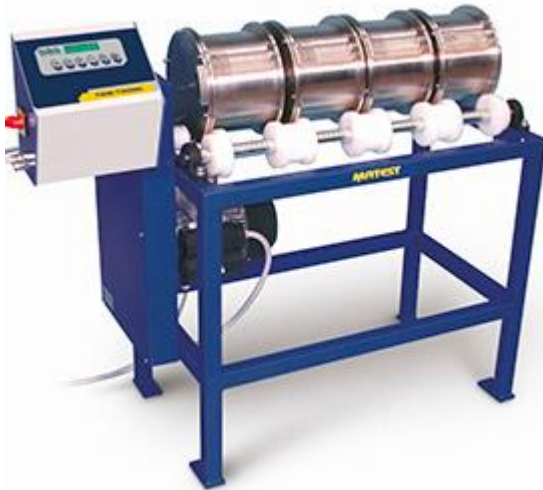
A2. pav. Standartinė mikro-Devalio mašina (LST EN 1097-1:2011)
