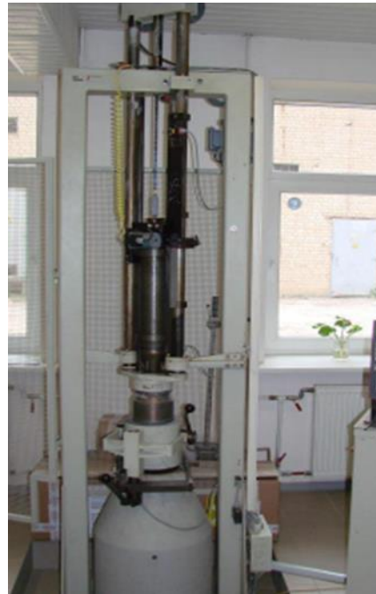
A4. pav. Atsparumo smūgiams nustatymo įrenginys ( LST EN 1097-2:2010 )
