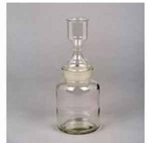
A5. pav. Vandens vonelė su piknometru (LST EN 1097-6:2013)
