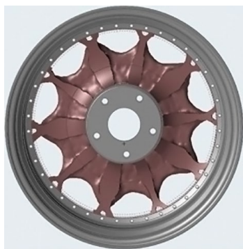
4 paveikslas. Aliuminio lengvojo lydinio ratlankio modelio pavyzdys, nupieštas CAD programine įranga (Yin et al., 2020)
