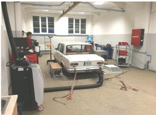
1 pav. Lengvasis automobilis įtvirtintas CARTEC LPS 2510 stende su prijungtu deginių analizatoriumi TECHNTEST 488
