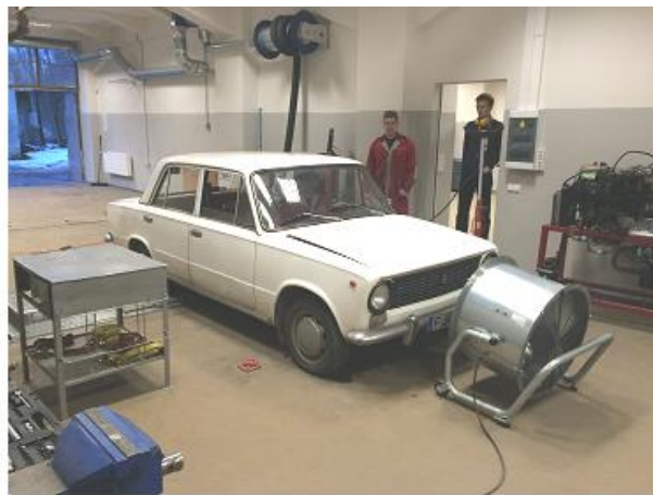
1 pav. Lengvasis automobilis įtvirtintas CARTEC LPS 2510 stende su prijungtu deginių analizatoriumi TECHNTEST 488
