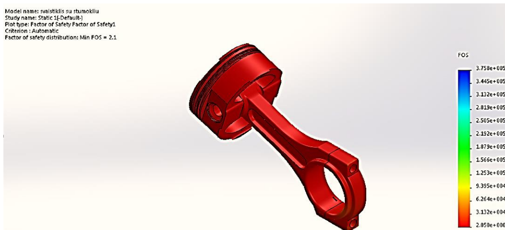
5 pav. Variklio detalių atsparumo skaitinis modeliavimas SolidWorks programa
