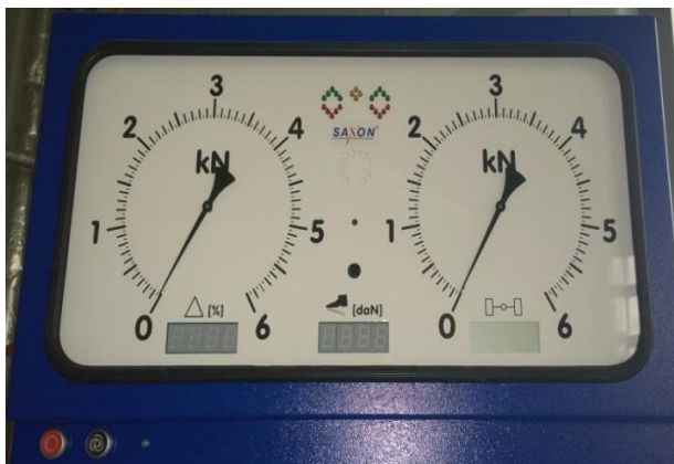
1 pav. Stabdžių patikros stendo „Saxon“ B 60 centrinis ekranas (kairėje) ir svėrimo plokštės „Dini Argeo“ (dešinėje) Šaltinis: sudaryta autorių
