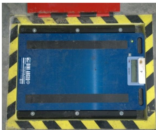
1 pav. Stabdžių patikros stendo „Saxon“ B 60 centrinis ekranas (kairėje) ir svėrimo plokštės „Dini Argeo“ (dešinėje) Šaltinis: sudaryta autorių
