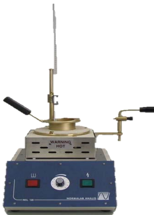
4 pav. Atviro tigelio prietaisas pliūpsnio temperatūrai nustatyti
