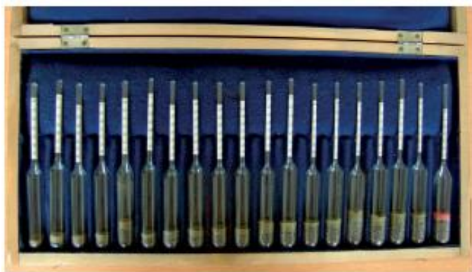
3 pav. Tankio nustatymas prietaisai: a - areometrų rinkinys, b -areometras
