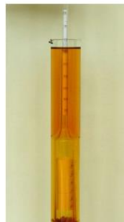
3 pav. Tankio nustatymas prietaisai: a - areometrų rinkinys, b -areometras
