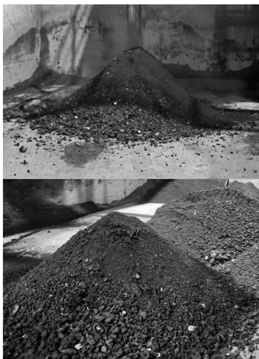
2 pav. Komunalinių atliekų deginimo termofikacinės jėgainės (UAB Fortum Heat Lietuva ) dugno pelenų saugojimo patalpa
