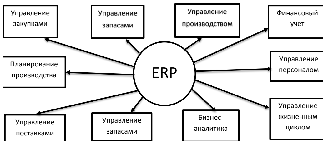
Рисунок 2 – Блок-схема модулей ERP системы
