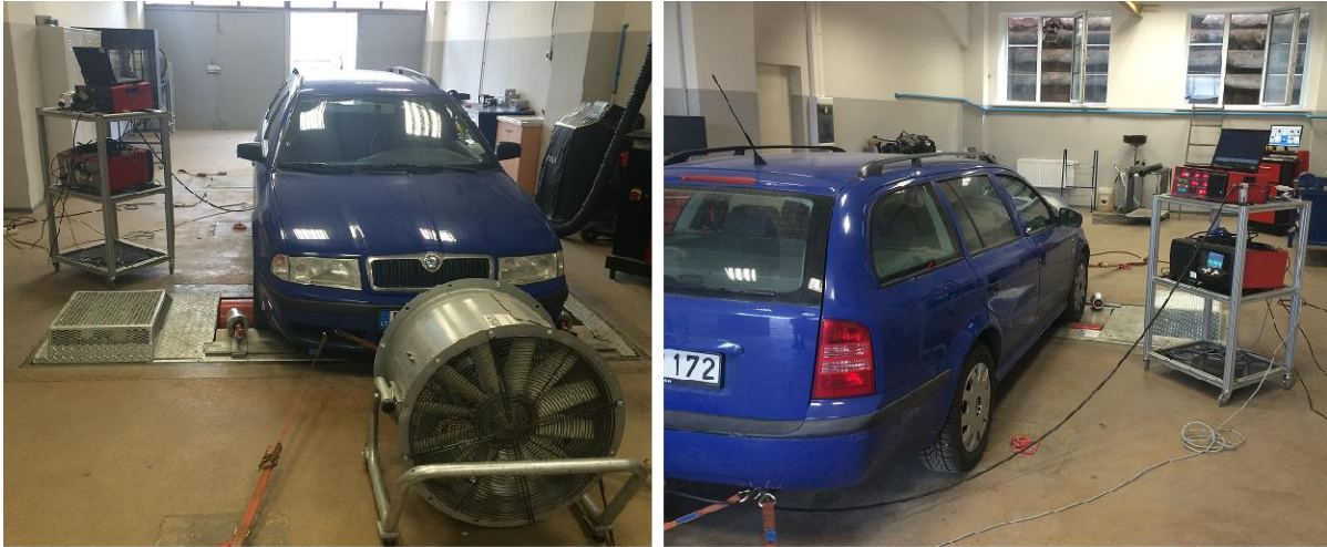
1 pav. Lengvasis automobilis įtvirtintas CARTEC LPS 2510 stende ir su prijungtais deginių analizatoriais TECHNOSTEST 488 ir CARTEC LCS 2400
