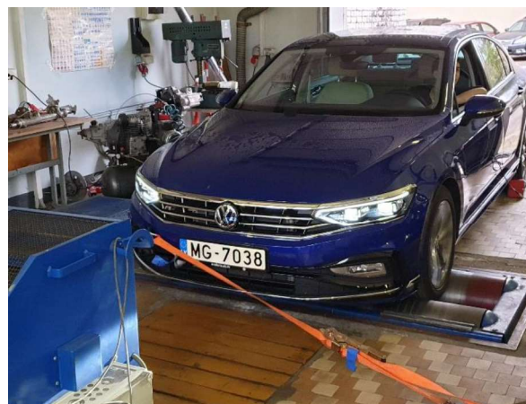
3 pav. Benzininio automobilio bandymas
