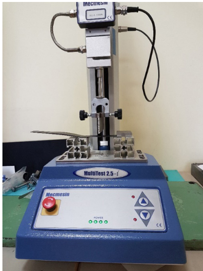
2 paveikslas. Mecmesin MultiTest 2.5-i bandymo stendas Figure 2. Mecmesin MultiTest 2.5-i testing stand
