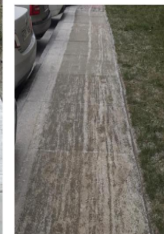
Skirtingų ledų tirpdančių medžiagų išbandymas ant įrengto modulinio šaligatvio.
