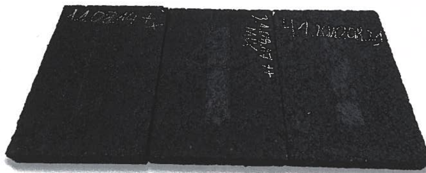
5 pav. SMA 8 S mišinio su skirtingais mineraliniais milteliais bandiniai (iš kairės į dešinę: su klinčių, granito ir dolomito mineraliniais milteliais) po 20 000 apkrovimo ciklų, esant 60 °C temperatūrai
