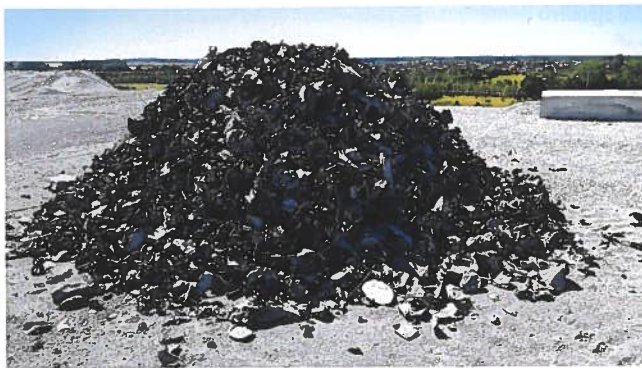
5 pav. Iš šlako atskirti metalai: juodieji metalai (viršuje) ir spalvotieji metalai (apačioje)
