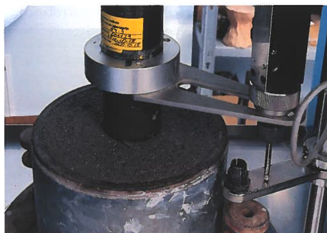
9 pav. Šlako mišinių bandiniai po triašio bandymo (vidinės trinties kampo ir sankibos nustatymas)
