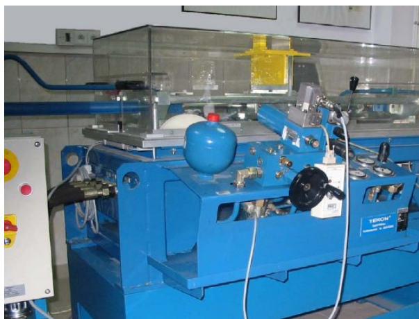
Rys. 5. Symulator hydrauliczny pracujący jako generator drgań mechanicznych (wymuszenia kinematycznego) działających na badany element hydrauliczny
