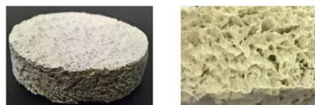
4 paveikslas. Nesukepinto stiklo putplasčio pavyzdys ir detalės makrostruktūra (D'Amore et al., 2017)
