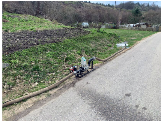
1 paveikslas. Debito matavimas tinklo plovimo metu
