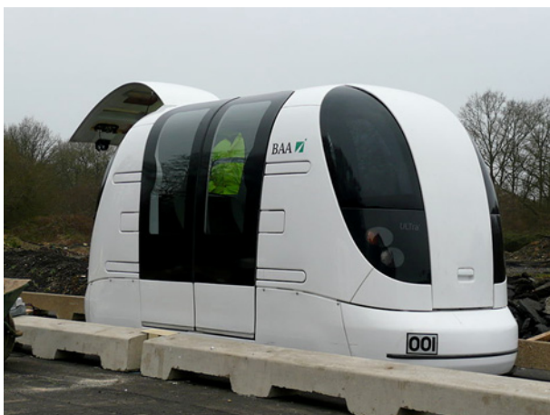
Рис. 5. Персональный автоматический транспорт (PRT) ULTra английской компании Advanced Transport Systems Ltd.
