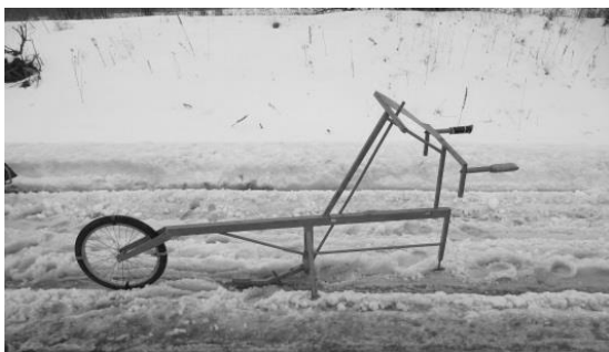
3 pav. Nelygumų matavimo prietaisas „Merlin“
