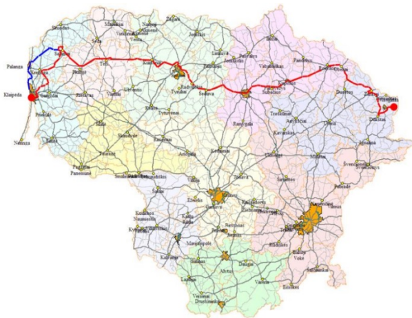
3 pav. Negabaritinių ir sunkiasvorių krovinių transportavimo maršrutas Klaipėda – Visaginas
