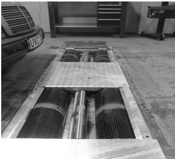
1 pav. Stabdžių efektyvumo patikros stendas JOHN BEAN
