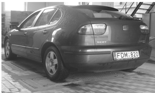
1 pav. Automobilis Seat Leon ant SAFELANE 400/800 amortizatorių patikros stendo
