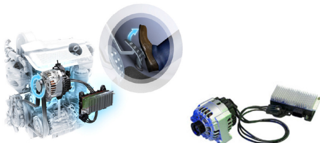
1 pav. Diržinės starterio-generatoriaus vaizdinė veikimo schema
