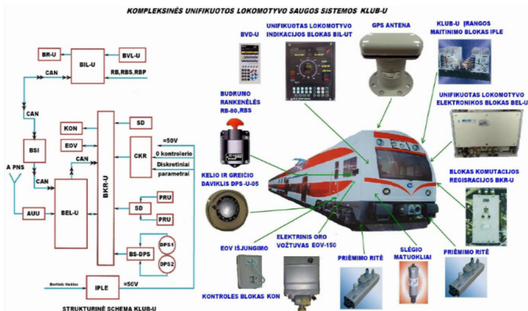
2 pav. Kompleksinė unifikuotos lokomotyvo saugos sistema
