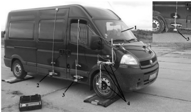
3 pav. Matavimo jutiklių išdėstymo schema: 1 – akselerometras ir giroskopas; 2 – optinis greičio jutiklis; 3 – lazerinis posvyrio jutiklis; 4 – rato padėties jutikliai
