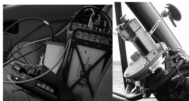
4 pav. Tyrimo naudota įranga: a) matavimo duomenų surinkimo įrenginys DAS-3 ; b) vairavimo robotas
