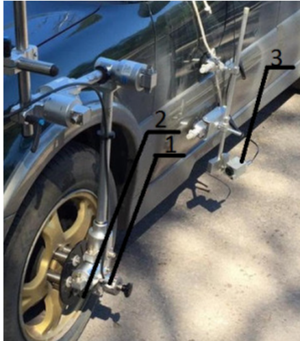
1 pav. Jutikliai: 1 – kampinio greičio jutiklis WPT ; 2 – lazerinis atstumo jutiklis HF-500C ; 3 – termokamera Optiris PI230
