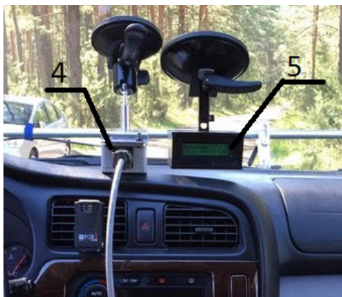
2 pav. Prietaisai: 4 – triašis akcelerometras ir gioskopas TANS-3 ; 5 – XL-Meter
