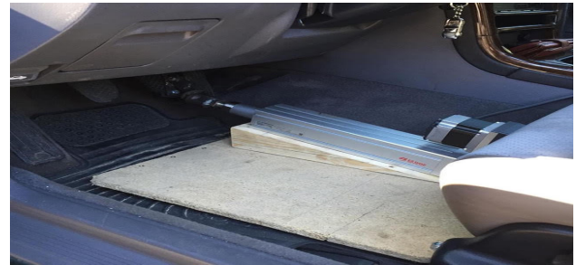
3 pav. Robotizuotas stabdžių pedalo paspaudimo sistema
