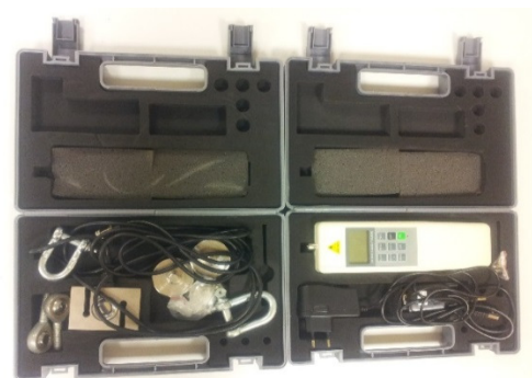
1 pav. Skaitmeninis dinamometras HP-20K
