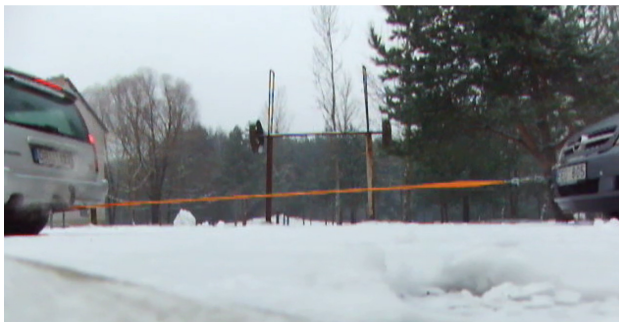
2 pav. Skaitmeninis dinamometras įjungtas tarp vilkties ir velkamojo automobilio, kurio salone – laidais su dinamometru sujungtas personalinis kompiuteris
