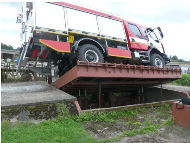
2 pav. Gaisrinio automobilio Renault D14 statinio posvyrio kampo nustatymas
