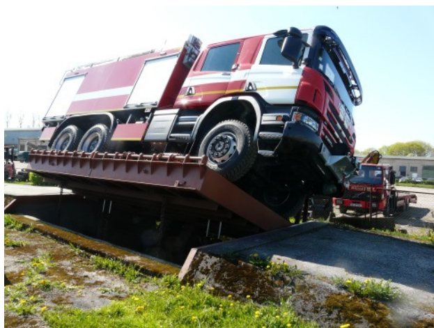
5 pav. Gaisrinio automobilio SCANIA P450 statinio posvyrio kampo nustatymas
