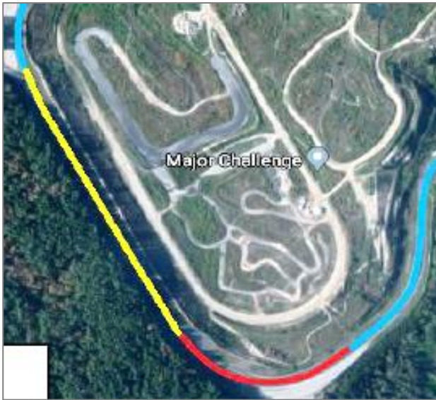
5 pav. Automobilio dinaminų savybių vertinimas konkrečioje žiedinių lenktynių atkarpoje.
