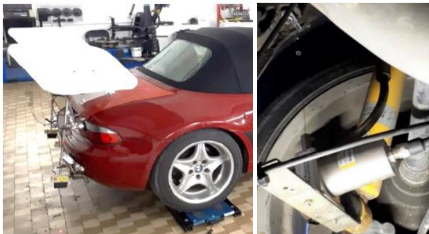
3 pav. Standumo koeficiento nustatymas pagal pakabos deformaciją.
