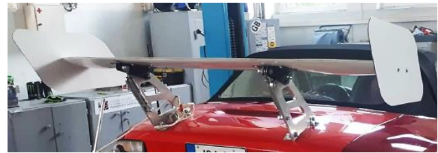
1 pav. Tyrime naudoto oro aptako prototipas.
