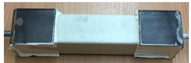
5 pav. Klijuotos jungties bandinys (plienas + stiklo pluoštas).
