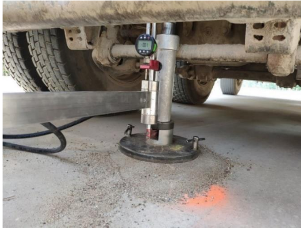
2.11 pav. k reikšmės tyrimai vietinės reikšmės kelyje Nr. 130 Fig. 2.11. k value investigation of local road No. 130
